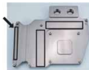
Области на VID-487, закрытые теплопроводными прокладками
